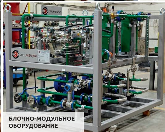
СИСТЕМА СМАЗКИ И АСЛОСНАБЖЕНИЯ ГАЗОТУРБИННОГО ДВИГАТЕЛЯ
